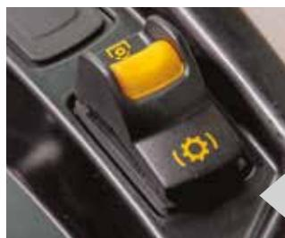
Priklučno PTO vratilo se aktivira elektro-hidraulički, preko sigurnosnog prekidača sa 3 pozicije (uključeno, isključeno, zaključano, kočnica).
