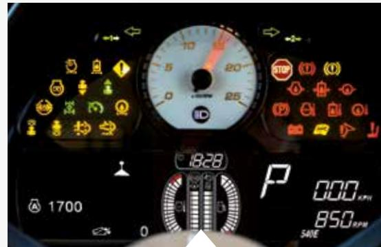
**Napredna instrument tabla** prikazuje broj obrtaja motora i PTO vratila, intervale servisiranja, potrošnju goriva, pređeni put, površinu na kojoj radite, temperaturu ulja i broj radnih sati traktora, memorisani broj obrtaja motora i informacije o servisu.
