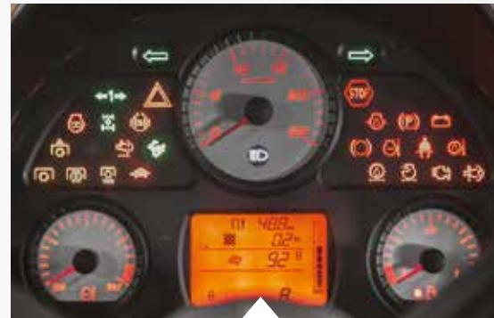
**Napredna instrument tabla** prikazuje broj obrtaja motora i PTO vratila, intervale servisiranja, potrošnju goriva, pređeni put, površinu na kojoj radite, temperaturu ulja i broj radnih sati traktora, memorisani broj obrtaja motora, informacije o servisu.
