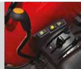
**Elektronski prekidači za uključivanje pogona na 4 točka i PTO vratila**
