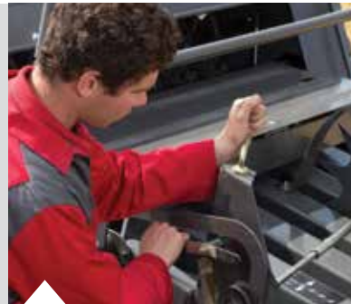
Einfache und zuverlässige Einstellung der Ballenlänge. Um eine exakte Steuerung der Ballenlänge zu erreichen und um bei allen Erntegutbedingungen eine hohe Messgenauigkeit zu gewährleisten, läuft das Sternrad zur Längenmessung mittig auf der Ballenkammer und bewegt sich synchron mit der oberen Klappe der Presskammer.
