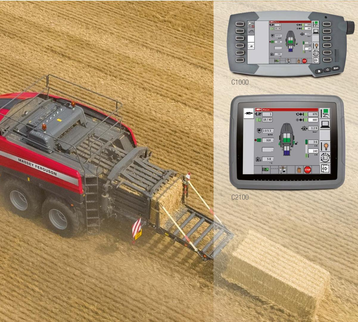
Sämtliche Vorgänge der Quaderballenpresse lassen sich schnell und einfach über das vollständig ISOBUS-kompatible C1000-Terminal und die exklusive Benutzeroberfläche **BaleCreate** steuern.
