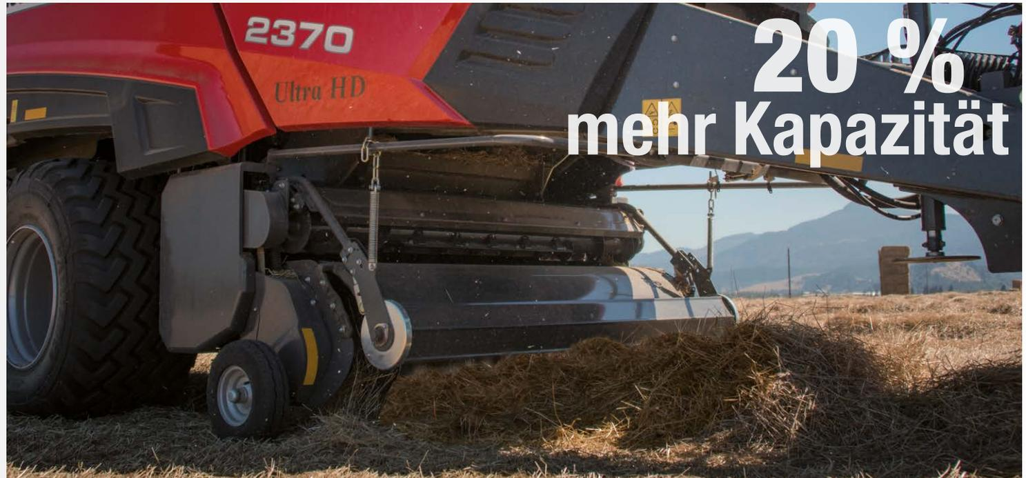
Die moderne OptiFlow-Pickup mit einer um 20 % höheren Aufnahmeleistung stellt sicher, dass die Ultra HD-Presser MF 2370 stets ein Höchstmaß an Durchsatzleistung erreicht.
