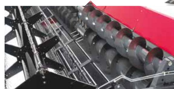
Kao opcija dostupan puž za uljanu repicu za PowerFlow heder povećava protok visokih useva u transporter i tako značajno povećava učinak. Dva električna bočna noža kompletiraju opremu za uljanu repicu.
