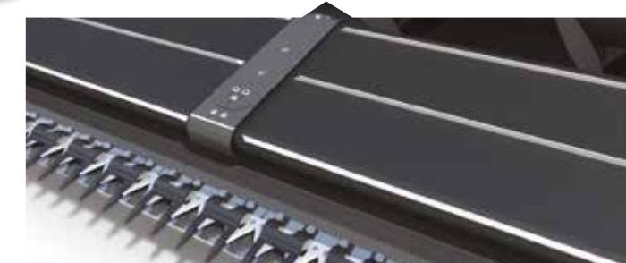
Nož je udaljen čitavih 1,14 m od puža, što daje optimalnu vidljivost i učinak. Robusne PowerFlow trake preuzimaju žetvenu masu od noža i ravnomernom brzinom je uvođe u pužni transporter. Trake takođe odbijaju kamenje da ne uđe u mašinu gde bi mogao da napravi štetu.
