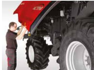
Jednodelni paneli sa svetlima omogućavaju brz pristup za održavanje
