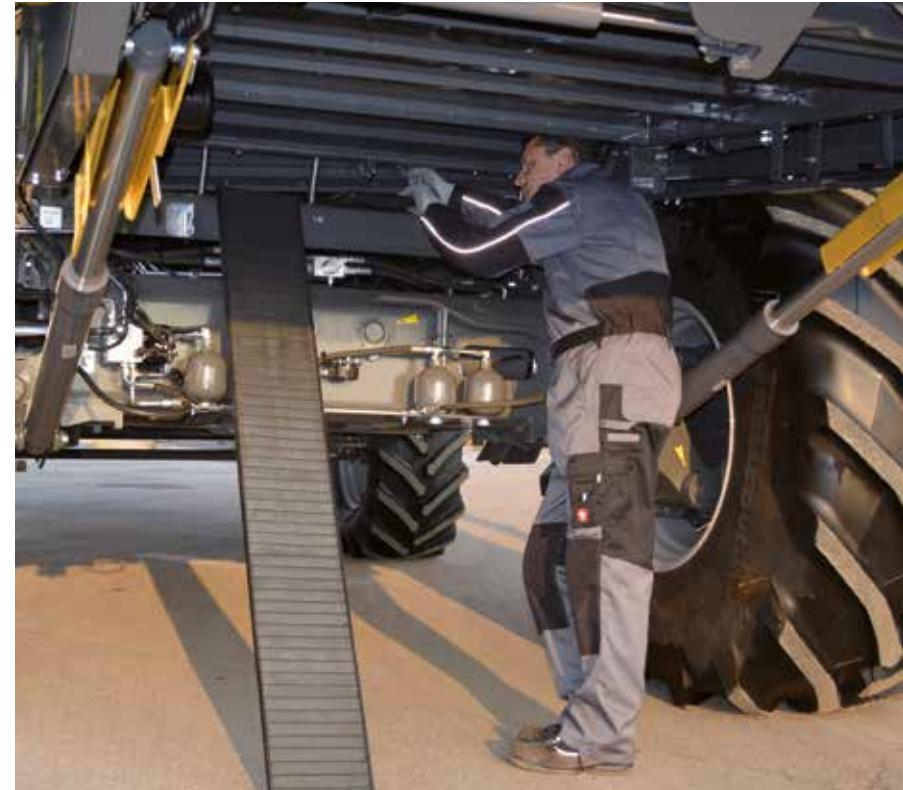
Jednostavan pristup novim sekcijama stepenastog poda koje se mogu ukloniti za brže i lakše čišćenje i servisiranje
