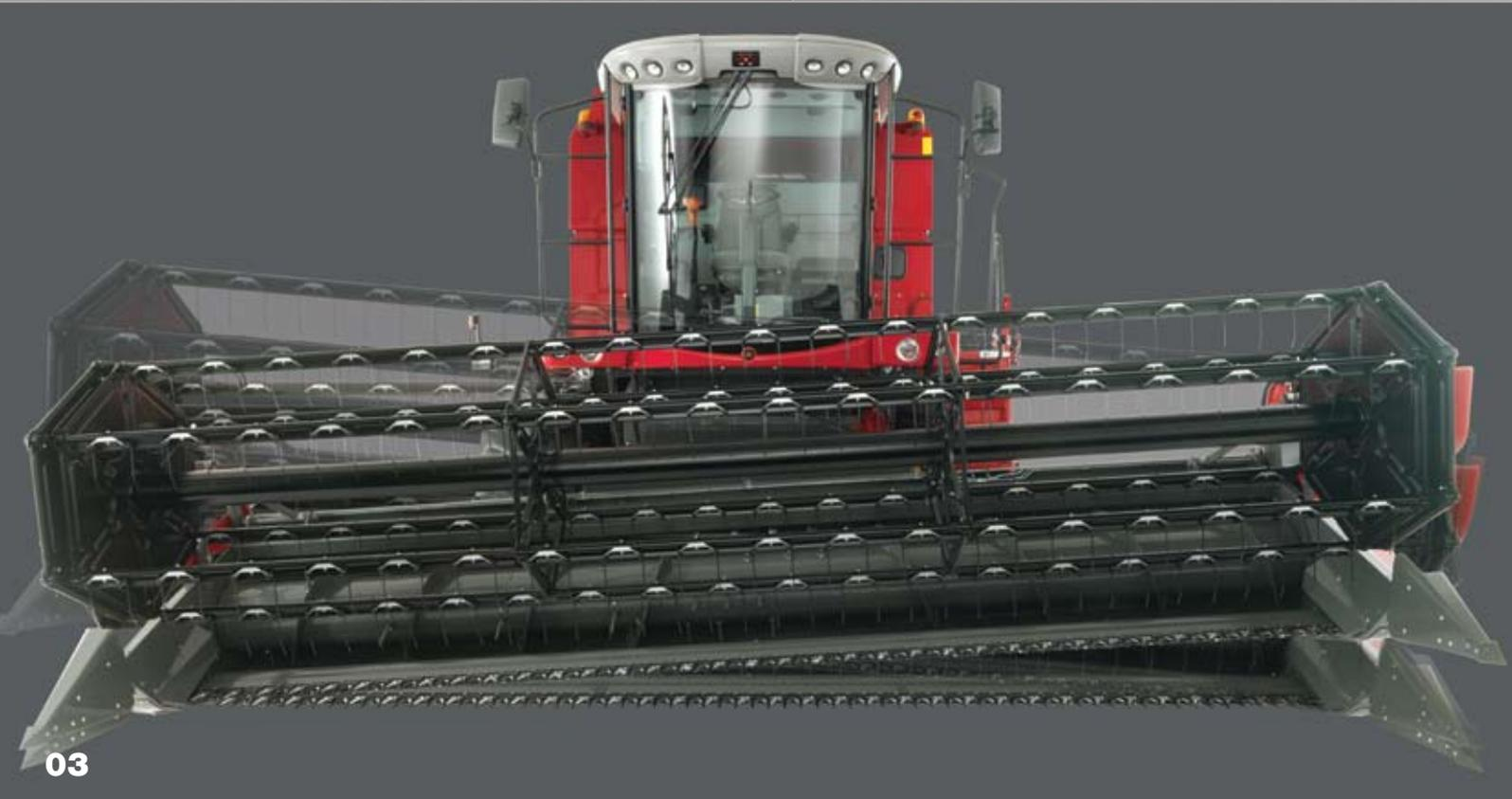
Dieses geniale System gleicht den Rumpf des Mähdreschers an Hängen durch Auspendeln der vorderen Achsantriebe aus. Dank dieser Korrekturvorrichtung können Hänge mit einem Gefälle von bis zu 20 Prozent ausgeglichen werden.
