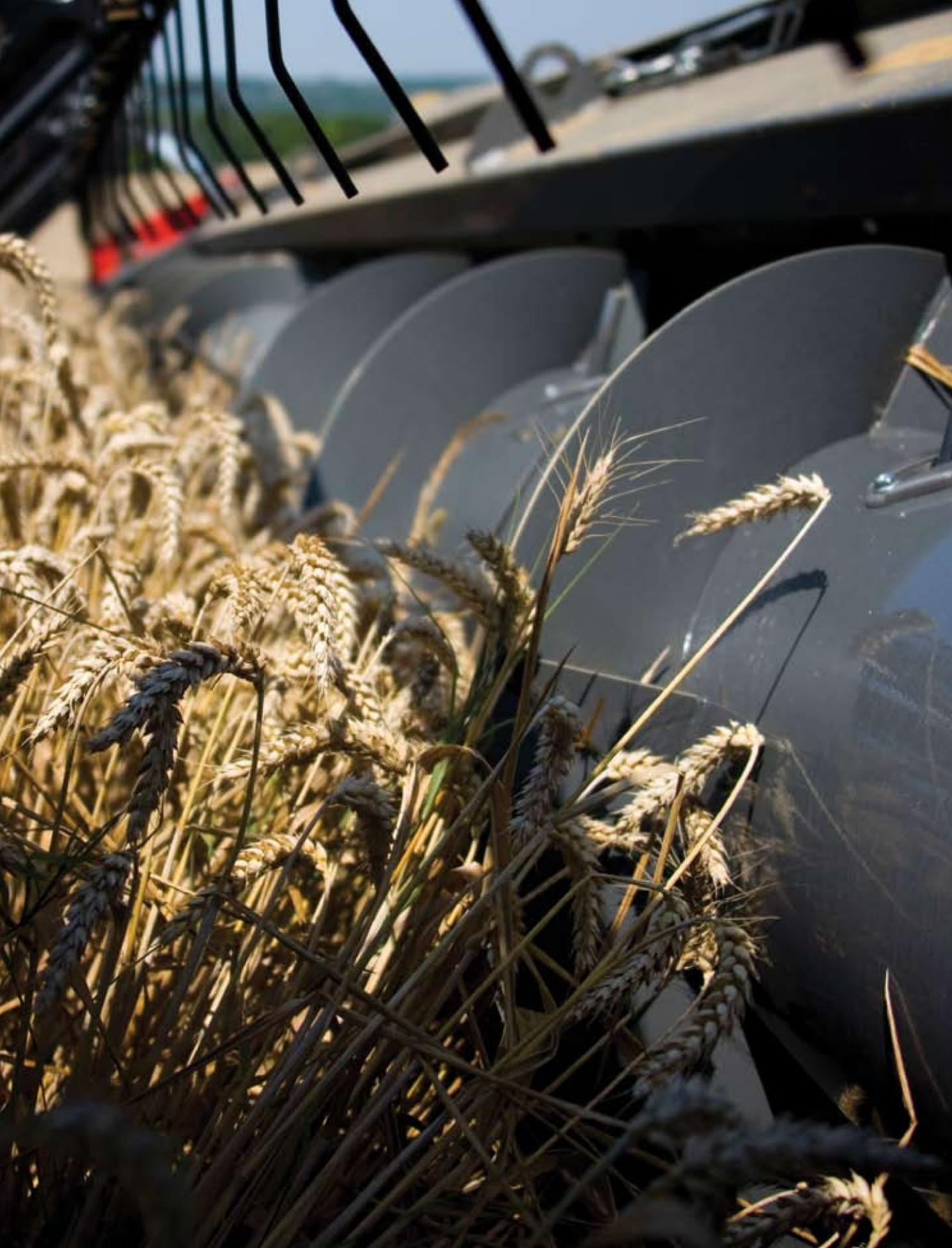
**01** Die Messer mit Doppelzacken werden von den geschlossenen Messerfingern geschützt, um maximale Haltbarkeit zu erzielen.
