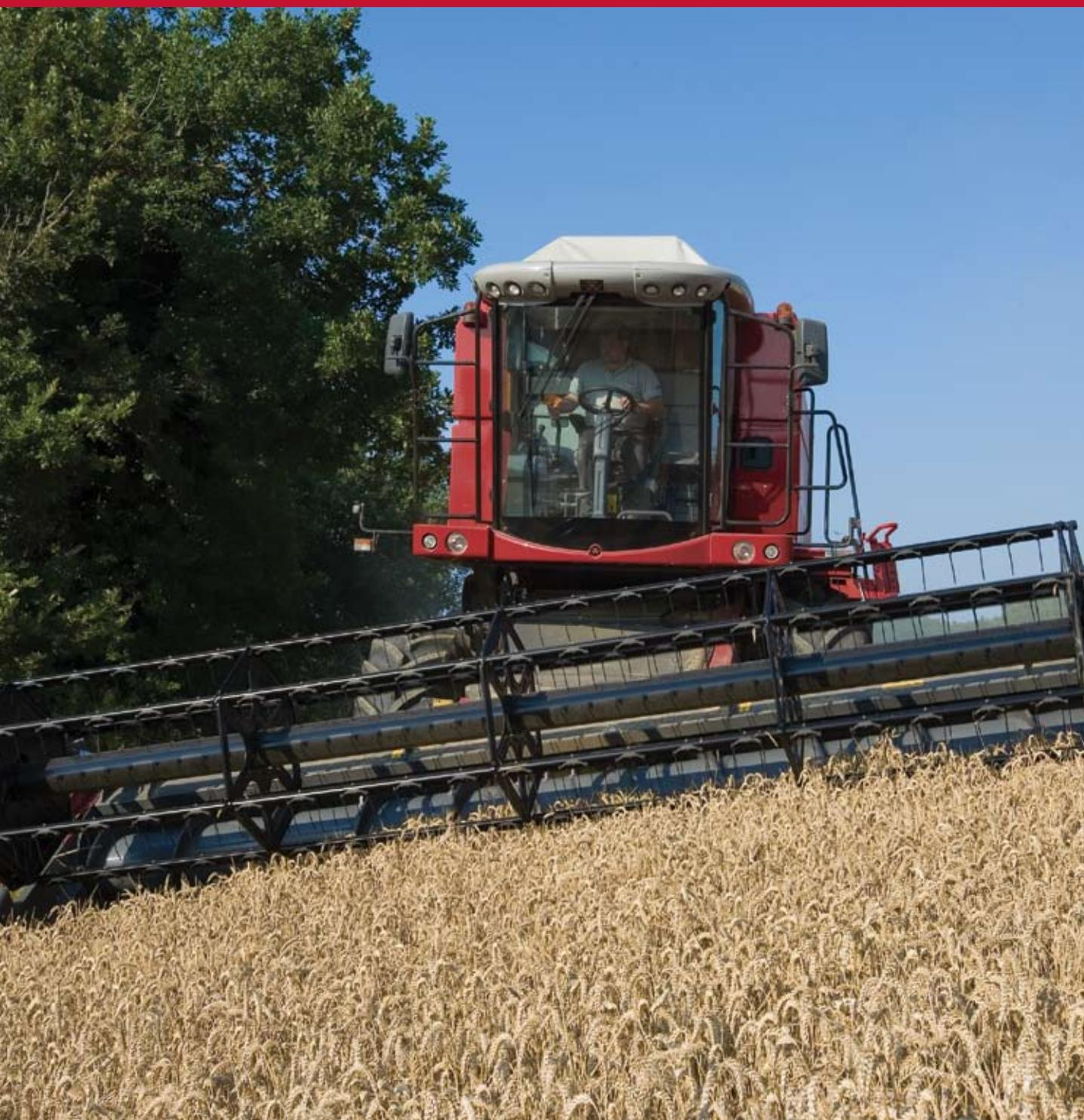
**01** Arbeiten an Hängen mit bis zu 20 % Gefälle dank Auto Level.
