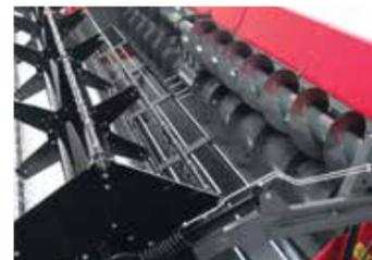
Die für das PowerFlow-Schneidwerk erhältliche, **optionale Rapsschnecke** optimiert den Einzug hoch wachsender Erntegüter in den Schrägförderer, sorgt so für einen deutlich höheren Durchsatz und verhindert Verluste. Zwei elektrische Seitenmesser komplettieren die Profi-Rapsausrüstung.
