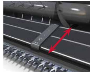
Für optimale Sicht und Leistung ist das Messer **ganze 1,14 m** von der Einzugsschnecke entfernt angebracht. Die robusten PowerFlow-Bänder nehmen das Erntegut nach dem Messer auf und führen es schnell und gleichmäßig zur Einzugsschnecke. Die Bänder werfen zudem Steine zurück aufs Feld bevor sie in die Maschine gelangen und dort Schaden anrichten.
