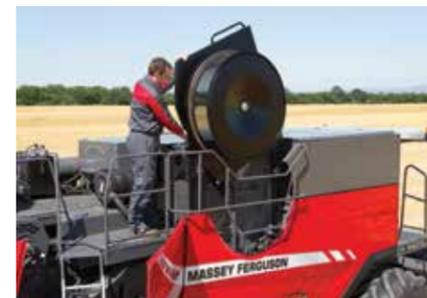
Durch den schnellen und bequemen Zugang zu den Kühlern für Reinigungs- und Wartungsarbeiten reduzieren sich die Standzeiten und der Kraftstoffverbrauch
