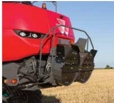
Für den Transport kann der **Maxi Spread Radialverteiler auf Knopfdruck bequem** hochgeschwenkt werden. Dieses einfache Verfahren dauert nur Sekunden und erfordert keine Werkzeuge. Per Knopfdruck kehrt man beim Wenden die Einstellungen für den „Maxi-Spread“ Radialverteiler und die Leitbleche des Häckslers um.
