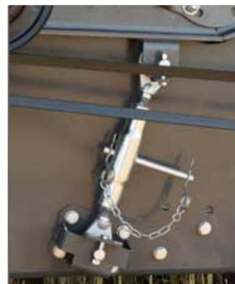
Die schnelle und einfache **Schneckenverstellung** animiert die Fahrer, die Einstellungen zu verändern, um für unterschiedliche Erntegüter den jeweils optimalen Durchfluss zu erzielen.
