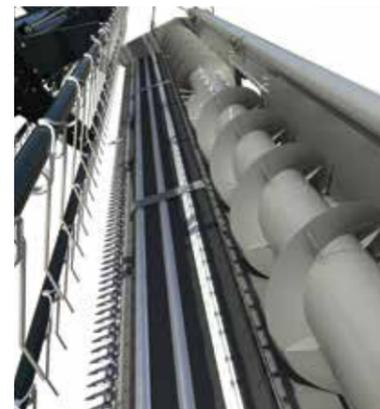
Die leistungsstarke, 762 mm hohe **SuperFlow-Einzugsschnecke** mit Einzugsfingern über die gesamte Breite ermöglicht unter allen Bedingungen und bei jedem Erntegut ein zügiges Arbeiten – keine Haufenbildung, nur ruhige, gleichmäßige Zufuhr.
