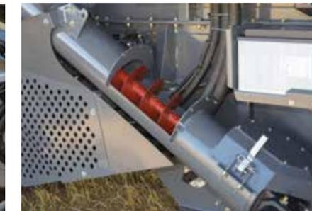
Das Nachdreschsystem ist mit einem einfach austauschbaren Abdeckblech für Raps und Hülsenfrüchte ausgestattet, das eine schnelle Anpassung der Einstellungen im Feld ermöglicht.
