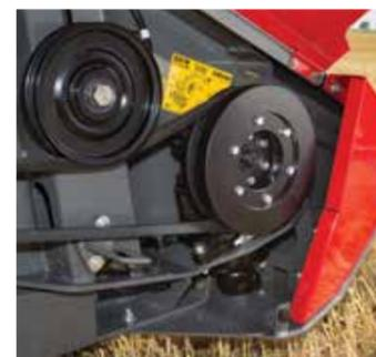
Der **Schumacher-Messerbalken** mit Doppelantrieb erlaubt mit seiner hohen Geschwindigkeit einen sehr hohen Durchsatz. Der beidseitige Antrieb des 10,74 m Schneidwerks entlastet die einzelnen Antriebe für noch höhere Zuverlässigkeit.
