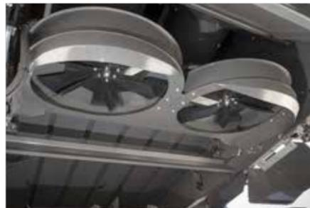
Der hydraulisch angetriebene **Spreuverteiler** ist stufenlos verstellbar und kann mit Hilfe von Gasdruckfedern bequem nach hinten geschwenkt werden, wenn Zugang zu den Sieben erforderlich ist.
