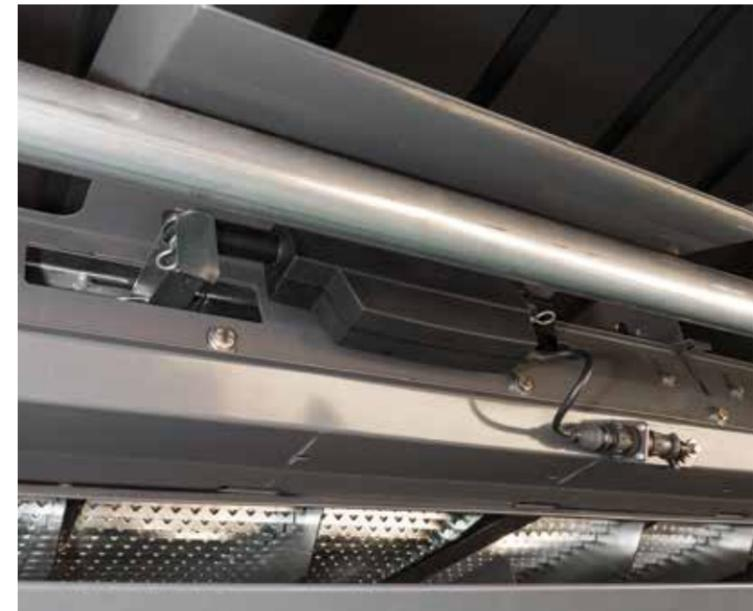
Das patentierte Überkehrsystem nutzt Förderschnecken für den Transport und ein Schaufelrad, um die Überkehr zurück zum Siebkasten zu transportieren. Ein effektiver Nachdrusch und die so wichtige gleichmäßige Verteilung im Mähdrescher, um eine Überlastung zu vermeiden, werden unabhängig von der Kapazität gewährleistet. Die Überkehrmenge wird kontinuierlich überwacht und in der Kabine angezeigt.
