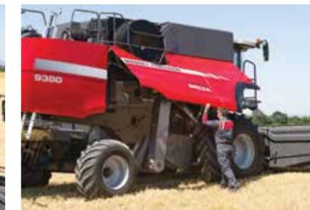
Einteilige Seitenverkleidungen mit innenliegenden Scheinwerfern bieten Tag und Nacht bequemen Zugang für schnelle und regelmäßige Inspektionen und erhöhen so die Zuverlässigkeit.
