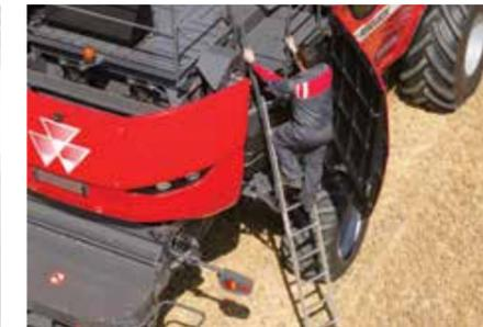
Schwenkbare Leiter für den bequemen Zugang zu Motor und Korntank.
