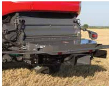
Für 9,2 m und 10,74 m breite Schneidwerke ist der „**Maxi-Spread**“ **Radialverteiler** erhältlich, der aus zwei schnell rotierenden Wurfscheiben besteht, welche die Ernterückstände gleichmäßig und sicher über die gesamte Breite verteilen. Die Drehzahl der Wurfscheiben kann von der Kabine aus gesteuert werden. Bei Arbeiten in windiger Witterung kann die Drehzahl der Wurfscheiben einzeln angepasst werden, um die Kraft des Windes auszugleichen.
