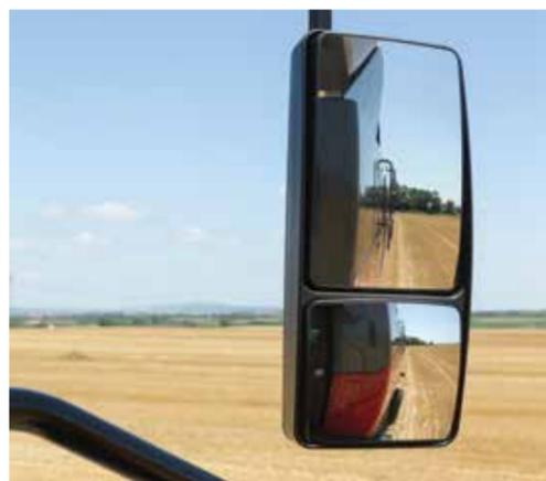
Exzellente Sicht auf die Seiten der Maschine durch zweigeteilte, verstellbare Spiegel
