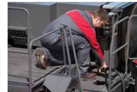
Die Einfüllstutzen für Kraftstoff und AdBlue liegen direkt nebeneinander und sind beide zur Reinhaltung der Tanks mit einem Primärfilter ausgestattet.
