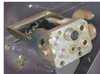
Der serienmäßige **Schnellkuppler** für Hydraulik und Elektrik sorgt für kürzeste Rüstzeiten.
