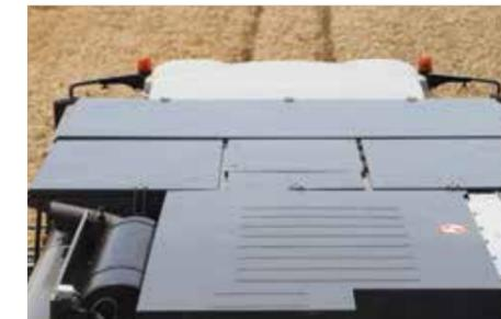
Die elektrisch öffnenden Korntankdeckel sind spritzwasserdicht.
