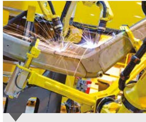
Robotizovano zavarivanje obezneđuje tačnost i stabilnost
