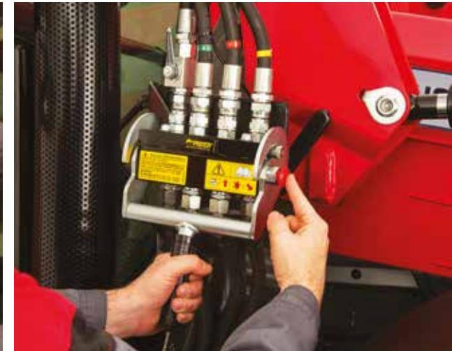
Razdvojite hidraulične i električne spojeve
