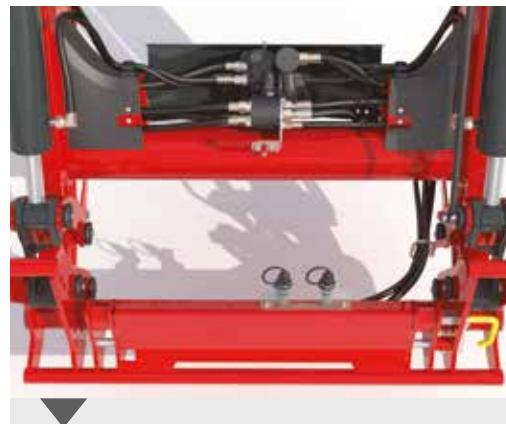
Poprečna cev prihvata hidraulične komponente i daje stabilnost bez uticaja na vidljivost
