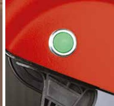
Svaki trn za zatvaranje ima zeleni marker na unutrašnjoj strani kućišta ležaja za jasnu vizuelnu potvrdu uskakanja trnova sa položaja vozača
