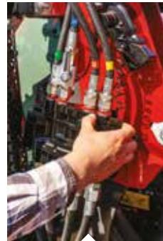
Osnovna konfiguracija sa ravnozapitavajućim pojedinačnim spojnicama
