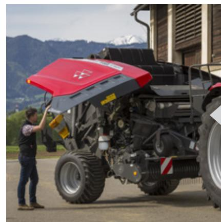
Bočna vrata pune širine obezbeđuju lak pristup za održavanje. Dizajn sa glatkom površinom sprečava nakupljanje prašine ispod panela, dok sigurnosna blokada sprečava slučajno otvaranje i potencijalnu štetu.
