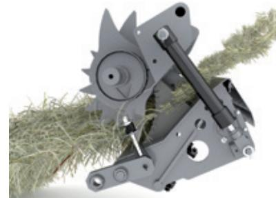
Patentirani zaštitni sistem sprečava da se veliko opterećenje pretvori u zagušenje nežnim spuštanjem poda koji visi na gumenim blokovima ili čeličnim oprugama, u zavisnosti od modela.
