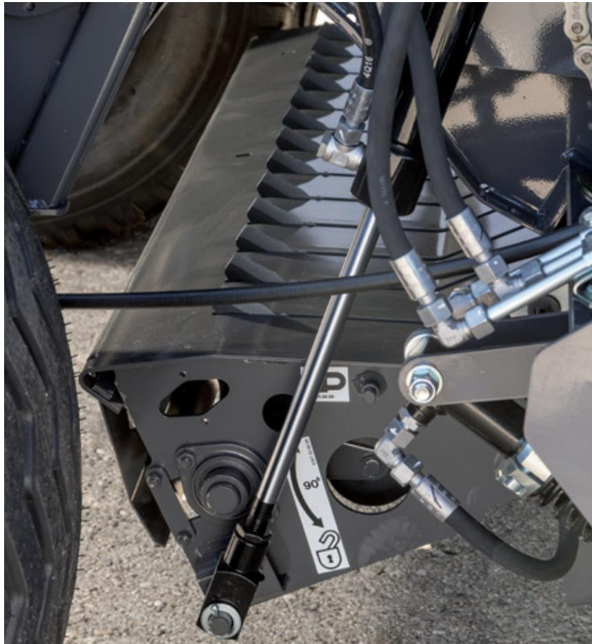
Prvi stepen primene Hydroflexcontrol omogućava kretanje prednjeg dela poda komore za ulaganje i automatski sprečava do 80% potencijalnog zagušenja, te vam omogućava da nastavite sa radom bez nepotrebнog zastaja.
