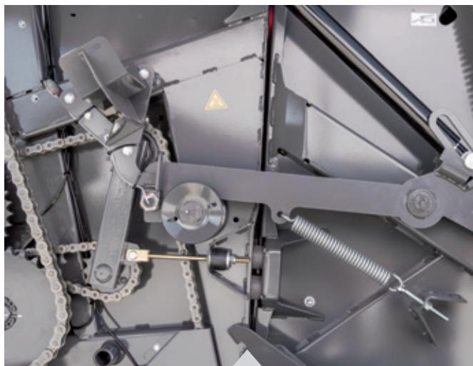
Mehanički uređaj za blokadu zadnjih vrata; jednostavan, brz i efikasan mehanizam koji obezbeđuje ravnomeren prečnik bale, veliku nabijenost bala i manju potrošnju energije.
