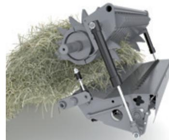
U slučaju zagušenja, operater može lako da otvori pod stola za ulaganje i da istovremeno spusti noževe kako bi se obezbedilo dovoljno prostora za prolazak mase.
