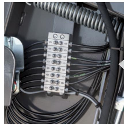
Redovno i dovoljno podmazivanje valjkastih ležajeva je od izuzetnog značaja, naročito u nepovolnjim uslovima, na primer tokom baliranja silaže. Centralizovane rezerve maziva za podmazivanje valjkastih ležajeva smeštene su na prikladne pozicije radi lakšeg pristupa i skraćenja vremena održavanja.
