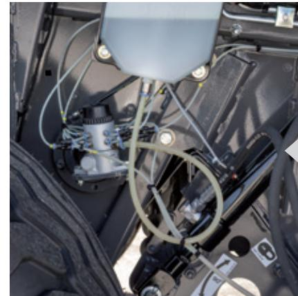
Automatsko podmazivanje lanca sa pojedinačnim podešavanjima za svaki lanac garantuje dovoljno snabdevanje uljem, smanjuje vreme održavanja i proizvaja radni vek lana. Za dodatnu dugotrajnost, u čitavom baleru se koriste samo lanci najvišeg kvaliteta.
